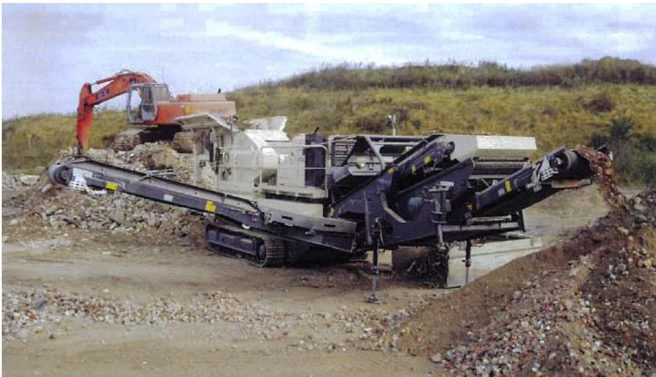
Figure 13 : Photo d'un cribleur concasseur Metso LT116s
