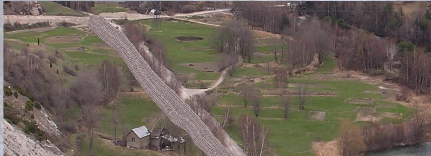
La réalisation du multitubulaire nécessite la réalisation d'un remblai d'environ 4 m de large en tête. La côte finale du remblai est située à 1085 NGF, soit un mètre au-dessus de l'actuelle piste Onera, et à la même côte que celle de l'aménagement définitif du site pour la phase travaux.
