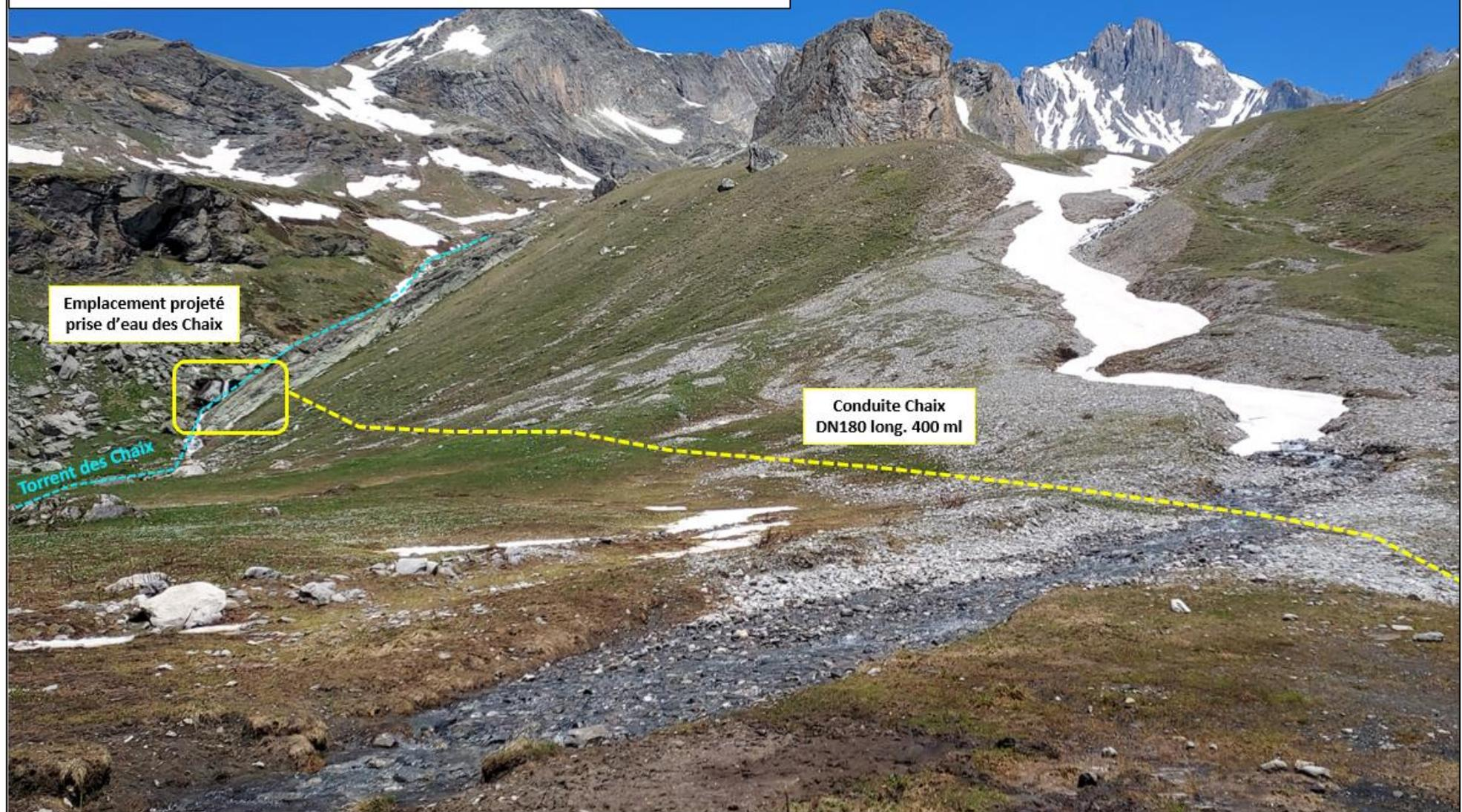
Photo n°3 – vue du positionnement de la prise d'eau de la Fournache
