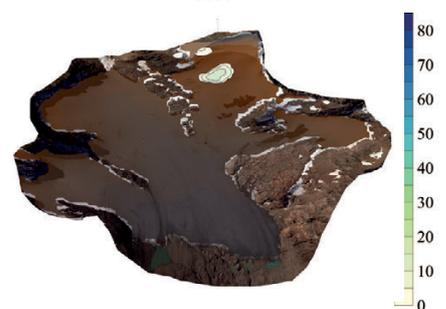
Figure 8. Extensions et épaisseurs du glacier de Saint-Sorlin au XXI<sup>e</sup> siècle avec un scénario climatique « modéré » et simulations climatiques issues d'un couple de modèles global/régional (CNRM/CNRM-CM5, RCP4.5). L'échelle des couleurs représente les épaisseurs de glace en mètres.
